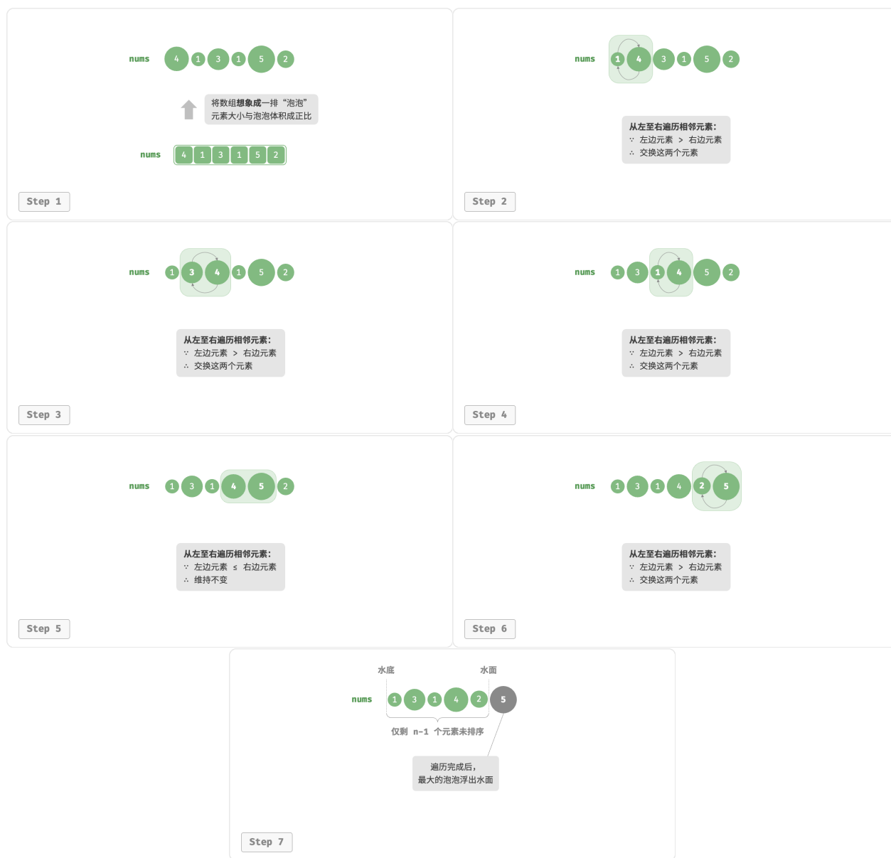
图 11-4 利用元素交换操作模拟冒泡
