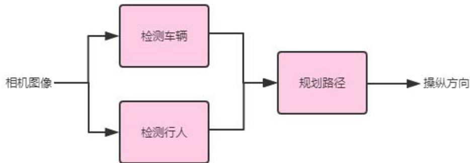
它拥有三个组件：一个使用相机图片检测车辆，一个检测行人，最后一个组件则为我们自己的车规划路径，从而避让车辆和行人。
