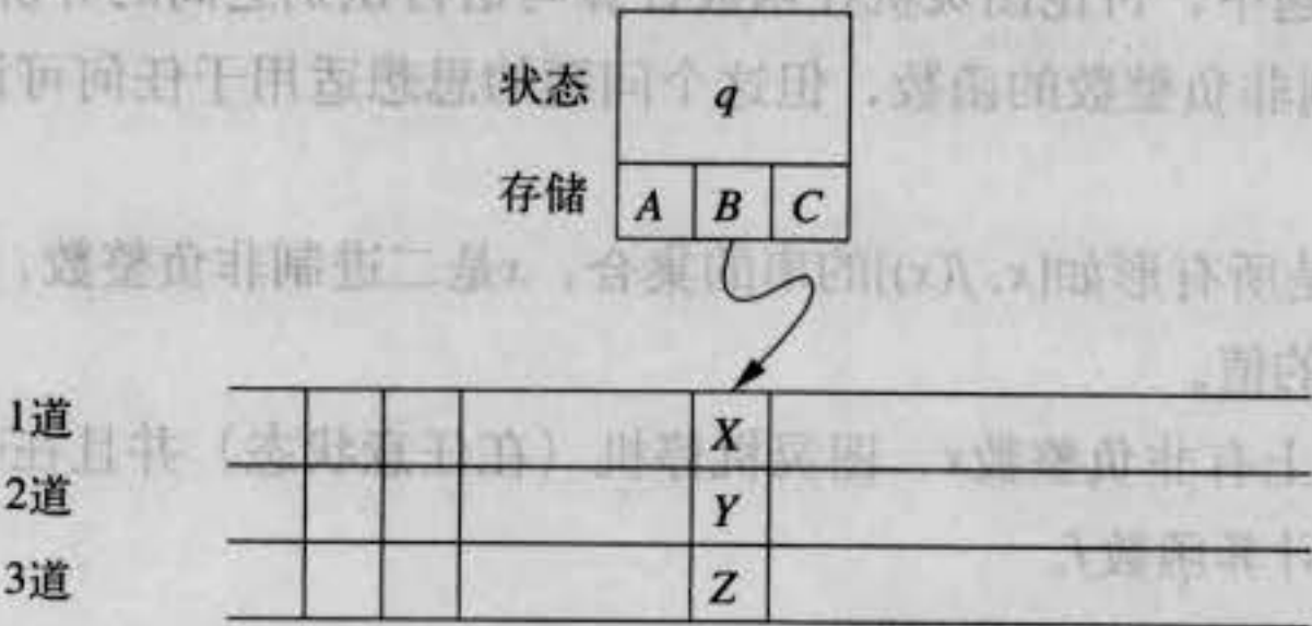
图8-13 认为图灵机具有有穷控制存储和多道
