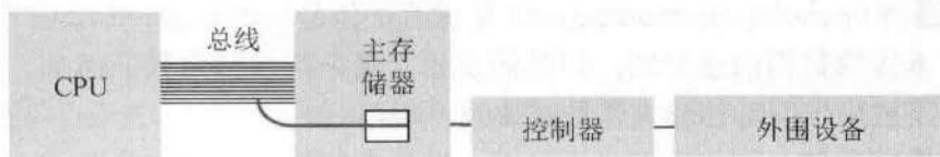
图2-14 存储映射输入/输出的概念表示
