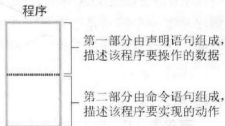
图6-4 一个典型的命令型程序或程序单元的结构
