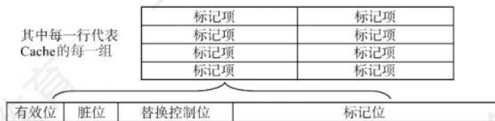
图 3.21 二路组相联的标记阵列示意图
